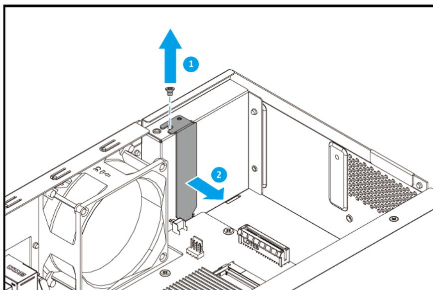
b. Retire la cubierta de la ranura.
