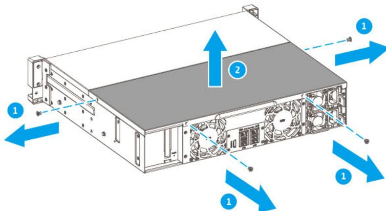
5. Retire la cubierta para PCIe.
