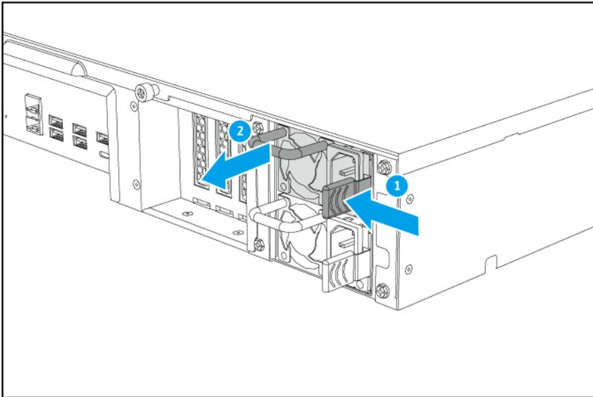
4. Setzen Sie die neue PSU ein.
