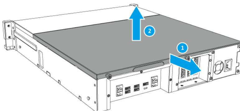
**6.** Entfernen Sie die PCIe-Abdeckung.
