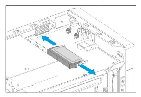
**b.** Verificare che il modulo sia inclinato verso l'alto e completamente estratto dallo slot.
