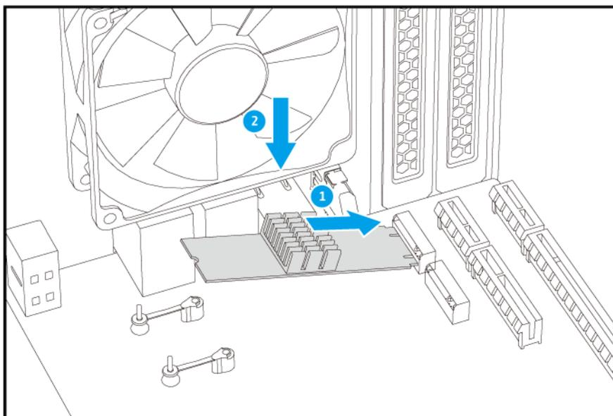
**c.** Inserire la puntina per assicurare ulteriormente il disco.
