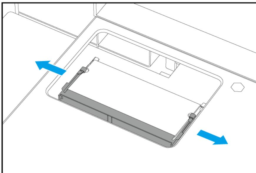
**b.** Verificare che il modulo sia inclinato verso l'alto e completamente estratto dallo slot. Tentare di rimuovere un modulo non completamente allentato potrebbe danneggiare il modulo e la scheda madre.
