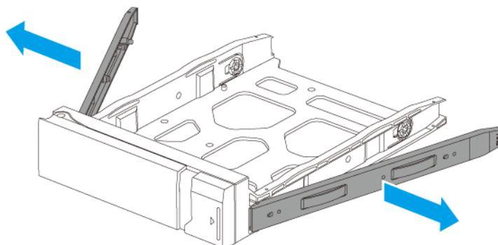
b. Posizionare l'unità sul vassoio in modo che i fori sui lati dell'unità siano allineati coi fori sui lati del vassoio.
