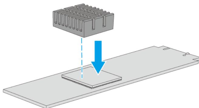
**7. M.2 SSD を取り付けます。****a. プッシュピンを引き出します。**
