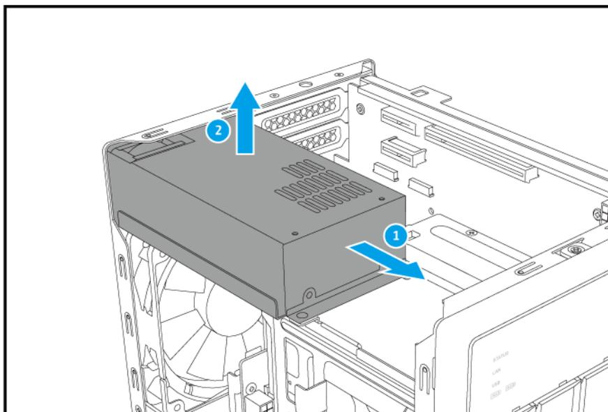
7. PCIe スロットカバーを取り外します。
