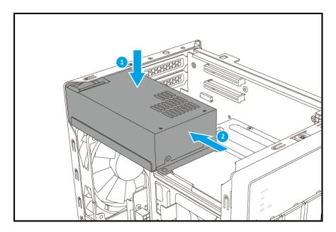
**b.** Inserire le viti che fissano l'unità allo chassis.
