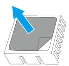
**c.** Installare il dissipatore di calore sul controller.
