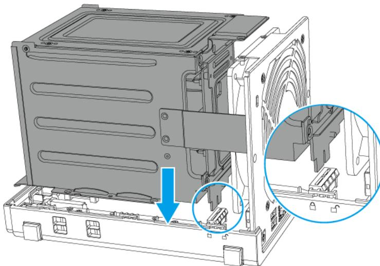
**12.** Collegare le viti che fissano lo chassis del vassoio unità al NAS.
