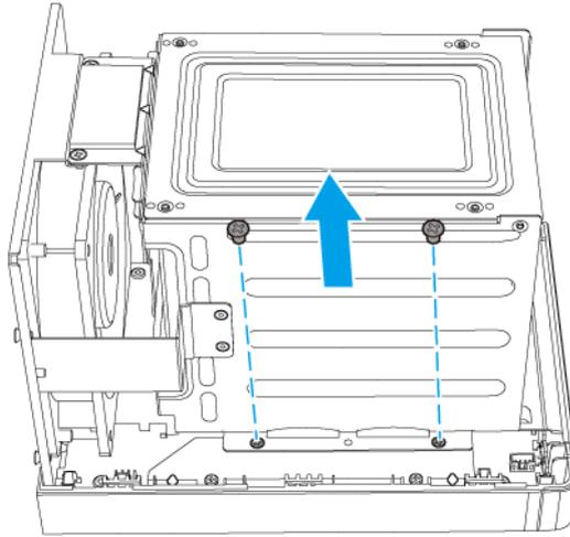
8. Sollevare lentamente lo chassis del vassoio unità fino a quando si stacca completamente dal NAS.
