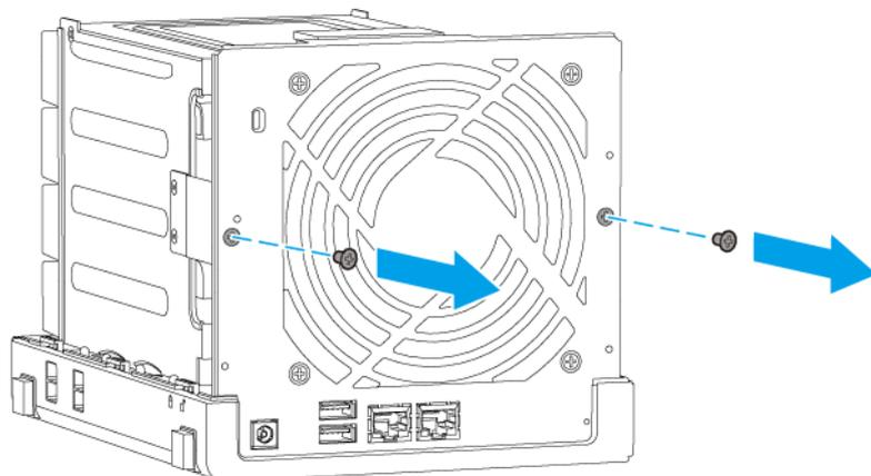
**7. Rimuovere le viti che fissano lo chassis del vassoio unità al NAS.**
