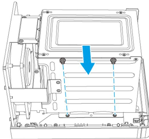
**13.** Collegare le viti che fissano lo chassis del vassoio unità sul lato posteriore del NAS.
