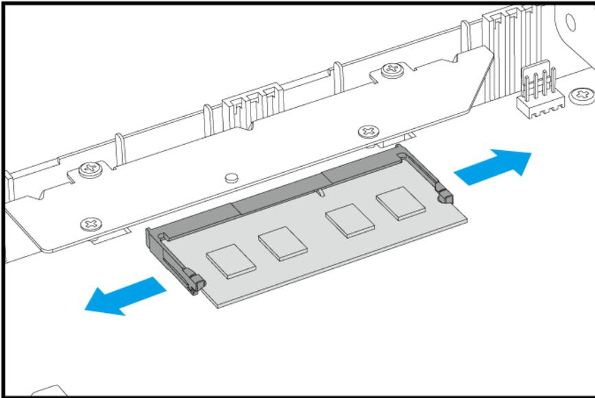
b. Verificare che il modulo sia inclinato verso l'alto e completamente estratto dallo slot.
